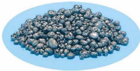
Fig 6: parte metallica del residuo del DMS
